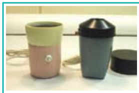
最早的用咖啡杯改造而成的 Eppendorf 离心机
