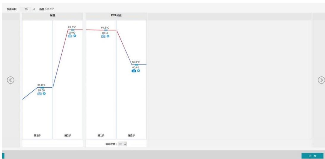
3. **设置孔板:** 运行条件设置完成后, 点击页面左侧孔板设置或者右下角的下一步, 进入孔板设置界面。在孔板视图任意区域单击鼠标右键选择定义和设置标准品, 对标准曲线进行定义, 请根据具体实验需求及情况, 对标准曲线的参数进行设定。根据实际反应管放置的相应孔位选择反应孔, 对样本及检测项目进行相应属性设置, 并勾选分配至对应孔位中, 待测样品孔位将显示相应设置属性
